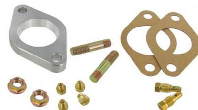
Adaptateur pour carburateur 39 mm vers collecteur 34 mm et kit de mise au point
