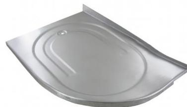
Tôle de châssis côté arrière
