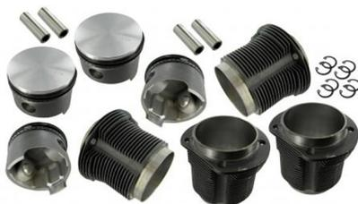
Jeu de cylindres et pistons du type big-bore 1915cc
