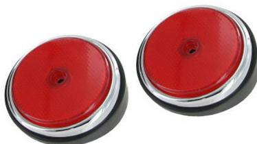
Réflecteurs latéraux arrière rouges avec boîtiers et joints, la paire Combi USA de 8.1967 jusque 7.1969
