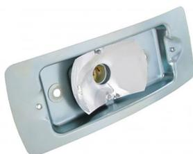
Support d'ampoule de clignotant côté gauche
