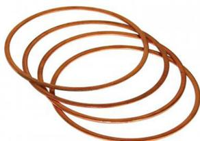
Rondelles en cuivre pour culasse (lot de 4 pièces) Moteurs type 1, Moteurs type 3, Moteurs CT/CZ, Épaisseur: 1,016mm, Diamètre extérieur: 98mm, Alésage: 90,5 et 92,0mm, Matériau: cuivre
