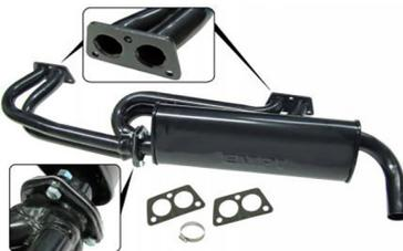
Pot/silencieux d'échappement du type Quiet Pack Type 4 uniquement pour moteur avec carburateur
