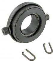
Butée d'embrayage/d'embrayage Cox 1300 et 1500 jusque 7.1970, Cox 1200 jusque 1972 (châssis 112 2670 582), Ghia jusque 7.1970, Combi jusque 7.1970, Type 3 jusque 7.1970, Type 181 jusque 7.1971
