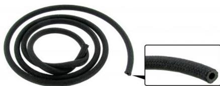
Durite/flexible d'essence avec extérieur en textile, au mètre diamètre intérieur: 5mm, diamètre extérieur: 9,5mm, pression de travail: 7 bar, pression de rupture: 30 bar, Remarque Approuvé pour l'essence fossile plombée et sans plomb E5, E10, E15, E85 et le diesel
