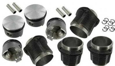
Jeu de cylindres et pistons du type big-bore 2276cc
