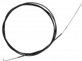
Câble de chauffage côté gauche
