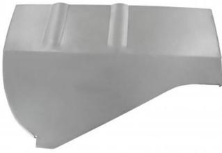
Panneau de réparation partie arrière de garde boue arrière droit
