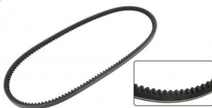
Courroie crantée trapézoïdale pour poulie de dynamo/alternateur
