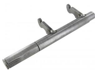
Axe de fourchette de débrayage/d'embrayage, diamètre 20 mm
