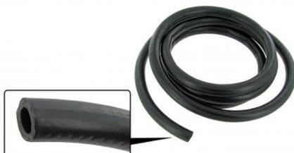
Durite/flexible d'essence renforcé avec textile à l'intérieur, au mètre Diamètre intérieur: 8,00 (max. 8,50mm), Diamètre extérieur: 13,70 (max. 14,20mm), Pression de travail: 7.5 bar, Pression de rupture: 30 bar, Remarque Approuvé pour l'essence fossile plombée et sans plomb E5, E10, E15, E85 et le diesel.
