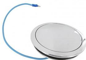
Cache-moyeu/klaxon de volant de direction pour le volant Nardi design Cox, Ghia, Combi jusqu'à 7.1979, Type 3
