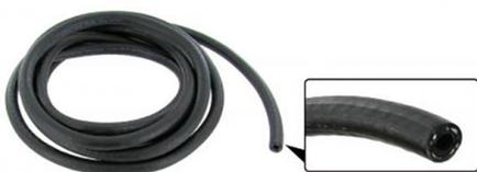
Durite/flexible d'essence renforcé avec textile à l'intérieur, au mètre
