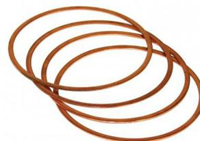
Rondelles en cuivre pour culasse (lot de 4 pièces) Moteurs type 1, Moteurs type 3, Moteurs CT/CZ, Épaisseur: 1,27mm, Diamètre extérieur: 98mm, Alésage: 90,5 et 92,0mm, Matériau: cuivre
