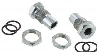
Bouchons pour boîte de ventilation de carter moteur, la paire Longueur totale: 32,4mm, Diamètre du côté du tuyau: 12,6mm, Diamètre du trou de montage: 16mm, Longueur du filetage: 14mm
