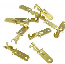
Cosses à sertir plates mâles sans isolation avec barbe, lot de 10 pièces Taille du connecteur: 6,3mm, Épaisseur du matériau: 0,8mm, Épaisseur du fil: 1,5-2,5mm 2
