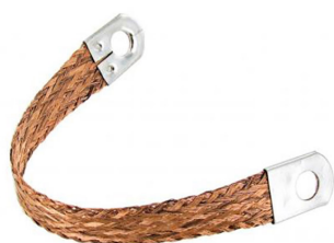
Tresse de masse 200 mm x 20 mm avec cosses 10 mm pour connecter la boîte de vitesses au châssis
