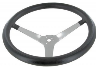
Volant de direction trois branches custom Diamètre: 37,5 cm, Profondeur: 108mm, utilisez les kits Boss #02740 ou #02742
