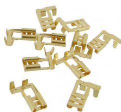
Cosses à sertir plates femelles coudées/angle 90° sans isolation sans barbe, lot de 10 pièces Taille du connecteur: 6,3mm, Épaisseur du matériau: 0,8mm, Épaisseur du fil: 1,0-2,5mm 2
