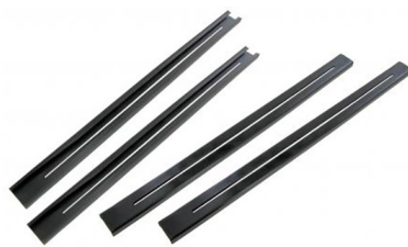
Coulisseaux en plastique pour siège (4 pièces) qualité A Cox de 8.1970 jusque 7.1972, Type 181 de 8.1970 et après
