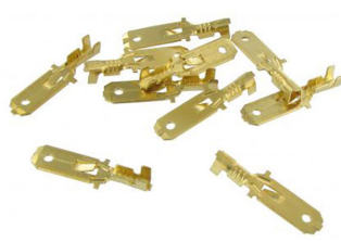
Cosses à sertir plates mâles sans isolation avec barbe, lot de 10 pièces Taille du connecteur: 6,3mm, Épaisseur du matériau: 0,8mm, Épaisseur du fil: 0,5-1,0mm 2
