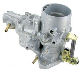
Carburateur Weber 34 ICT (la pièce) Gicleur d'alimentation essence: 135, Gicleur air: 160, Gicleur de ralenti: 55, Tube d'émulsion: F78
