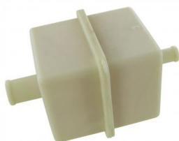
Filtre à essence, uniquement pour moteur injection Moteur type 1 jusque 1.1980, Moteur type 3, Moteur type 4 de 8.1974 et après, Moteur WBX code DH, raccords de tuyaux: diamètres 8mm et 12mm
